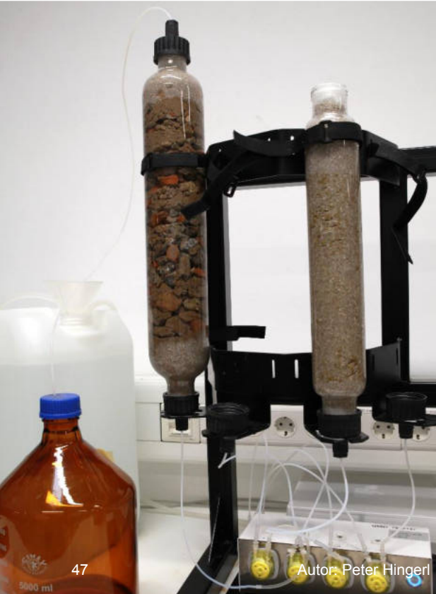
Schematische Darstellung des Säulenversuchs gem. DIN19528: 2009-01
