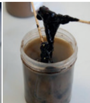
Abb. 2: Biomasseablagerungen an Filtern eines Dieselmotoren Filters
