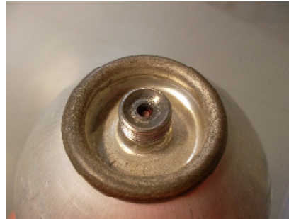
Bild 4: Ventil stark eingedrückt
