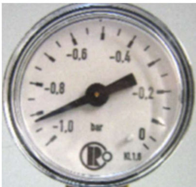
Abb. 3: Unterdruck prüfen, Manometer Linde
