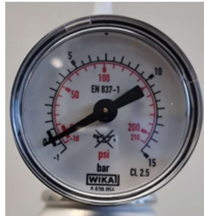
Abb. 6: vollständige Befüllung prüfen; Manometer Spectron
