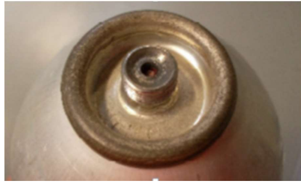
Abb. 2: Ventil beschädigt / undicht
