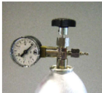
Abb. 4: vollständige Befüllung prüfen; Manometer Linde
